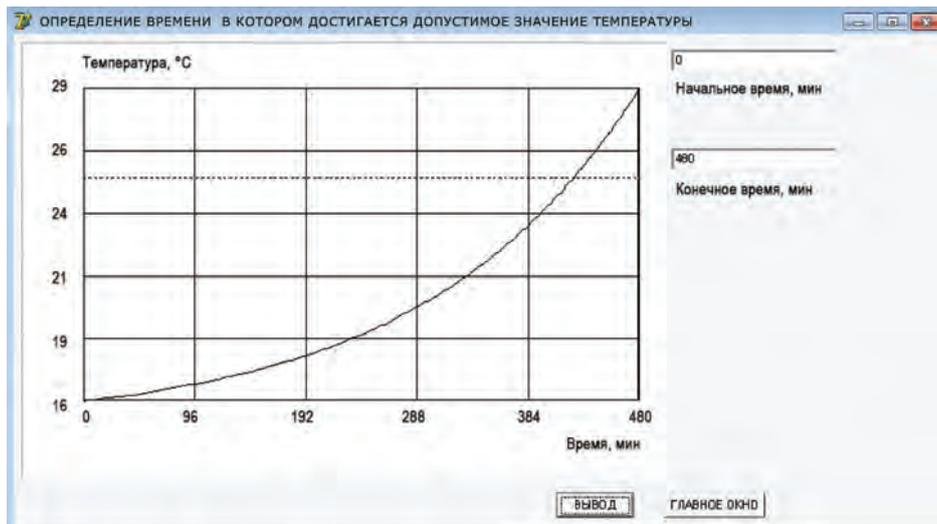
Рис. 8. График изменения временного диапазона, в котором достигается допустимое значение температуры
