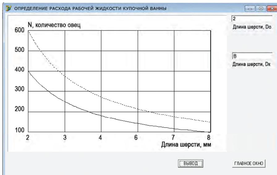
Рис. 10. График изменения обрабатываемого количества овец в зависимости от длины остаточной шерсти после стрижки
