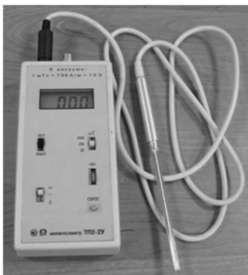
Рисунок 3 Миллитесламетр портативный универсальный ТП2-2У
