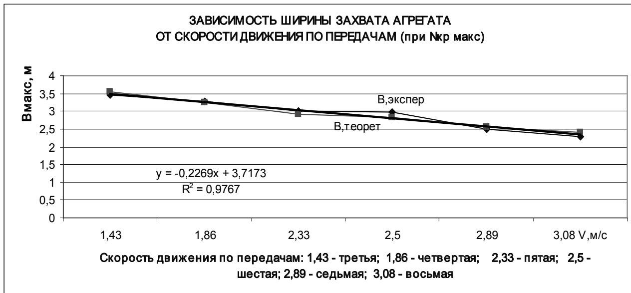
Рисунок 5 Зависимость ширины захвата МТА от передачи (трактор МТЗ-80)
