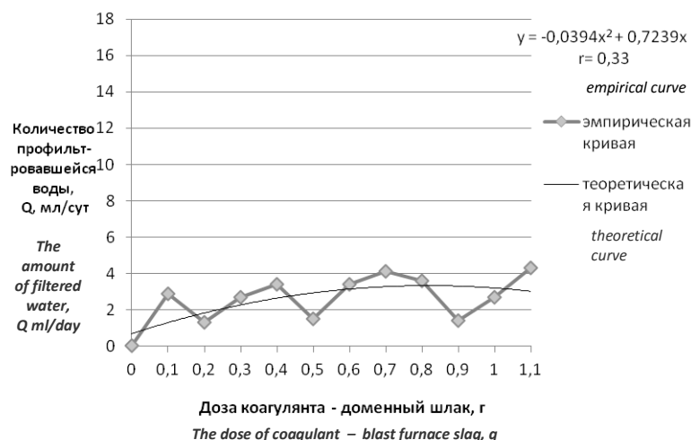
Рис. 2. Влияние доменного гранулированного шлака на фильтрационную способность бурового шлама Fig. 2. Granulated blast furnace slag effect on filtration capacity of drill cuttings
