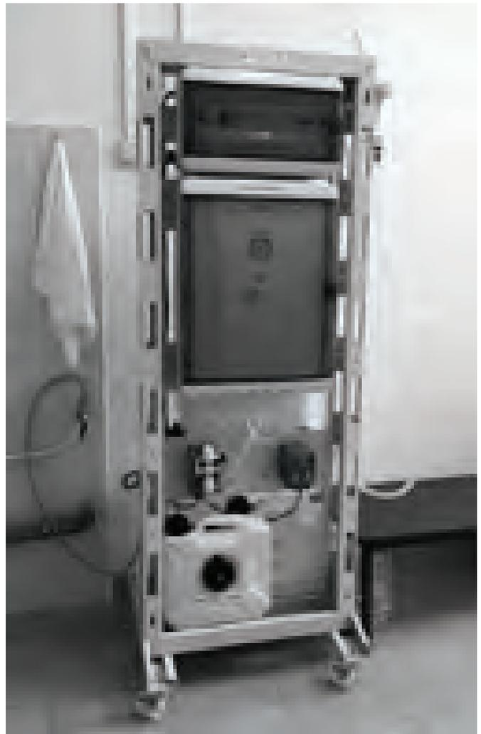
Рис. 1. Установки СТЭЛ для получения анолита АНК (источник: <http://vbinstitute.ru/equipment/stel>)
