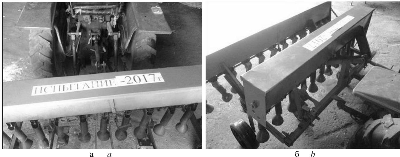
Рис. 2. Опытный образец сеялки травосмесей в агрегате с минитрактором Феншоу-180.
