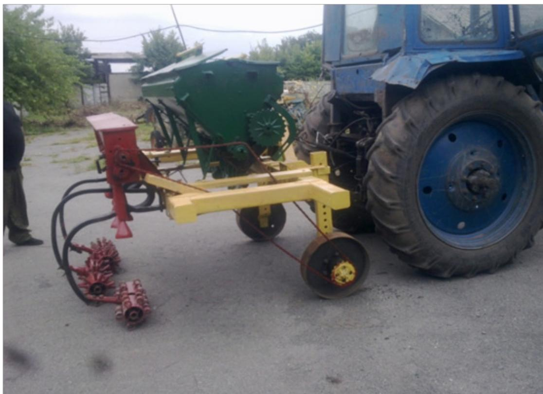
Рис. 4. Опытный образец блок-модуля многофункционального агрегата (вид опытного образца блок-модуля справа с трактором, вариант с прикатыванием)
