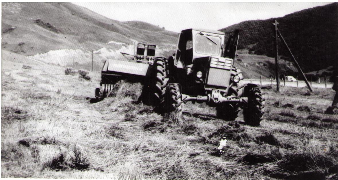
Рис. 2. Пресс-подборщик ПСБ-1.6Г. Работа на склоне
