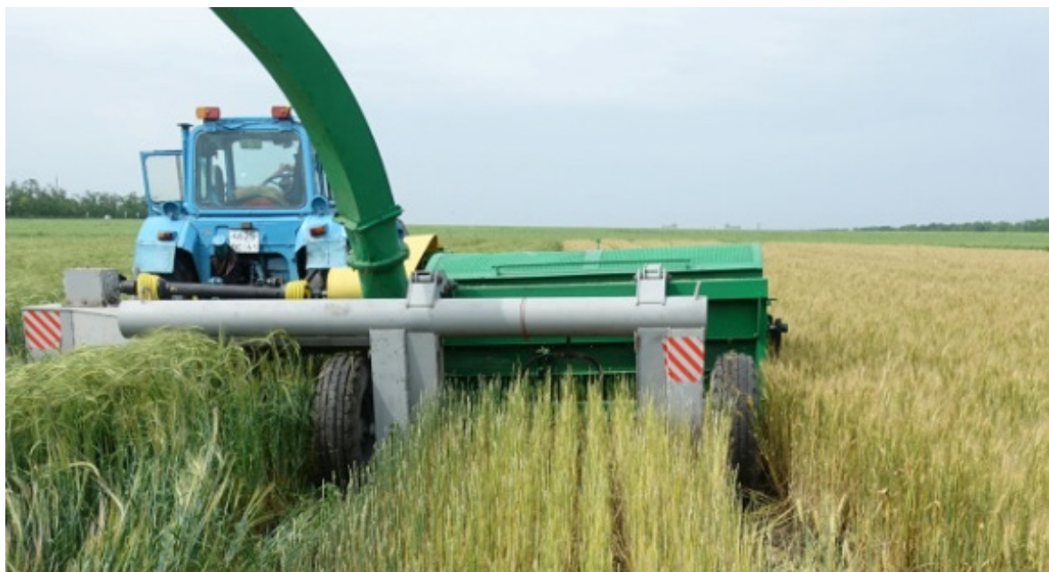
Рис. 1. Уборка озимой пшеницы прицепной очесывающей жаткой с загрузкой необмолоченного зернового вороха в транспортное средство
