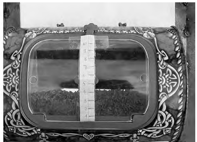
Рис. 3. Устройство пассивного действия для отбора проб зерна: а) верхняя головка нории с пробоотборником; б) вид пробоотборника спереди; 1 – пробоотборник; 2 – окно для установки пробоотборника; 3 – заслонка подвижная с выступом; 4 – шкала градуированная; 5 – буртики; 6 – головка нории; 7 – лента нории; 8 – ковши; 9 – ведущий барабан Fig. 3. Passive-action device for taking samples of wheat: а) upper head of a conveyer bucket with sampler device; б) the front view of sampler-device; 1 – sampler device; 2 – the window for installing the sampler-device; 3 – gate valve with a claw; 4 – calibrated scale; 5 – flanges; 6 – elevator head; 7 – elevator belt; 8 – elevator bucket; 9 – driving drum
