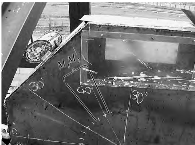
Рис. 3. Устройство пассивного действия для отбора проб зерна: а) верхняя головка нории с пробоотборником; б) вид пробоотборника спереди; 1 – пробоотборник; 2 – окно для установки пробоотборника; 3 – заслонка подвижная с выступом; 4 – шкала градуированная; 5 – буртики; 6 – головка нории; 7 – лента нории; 8 – ковши; 9 – ведущий барабан Fig. 3. Passive-action device for taking samples of wheat: а) upper head of a conveyer bucket with sampler device; б) the front view of sampler-device; 1 – sampler device; 2 – the window for installing the sampler-device; 3 – gate valve with a claw; 4 – calibrated scale; 5 – flanges; 6 – elevator head; 7 – elevator belt; 8 – elevator bucket; 9 – driving drum
