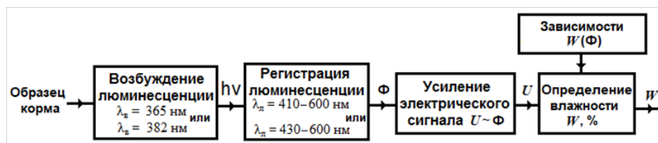
Рис. 5. Методика фотолюминесцентного определения влажности жмыхов
