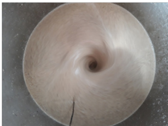
Рис. 2. Формирование воронки в процессе прохождения зерновой массы через ротор УПК-50 в процессе гидродинамического диспергирования Fig. 2. Formation of a funnel during the passage of grain mass through the UPK-50 rotor during hydrodynamic dispersion
